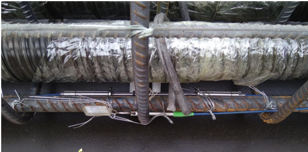
图 3.3.1 埋入式光纤光栅传感器安装图
