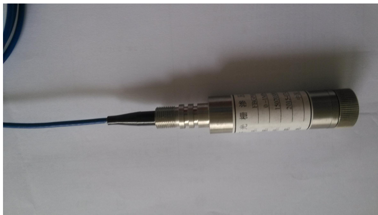
图1.2.2: ZX-FBG-SS01 光纤光栅渗压计
